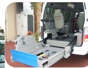
後部ドアからボタン一つで車いすでの昇降ができる!!
